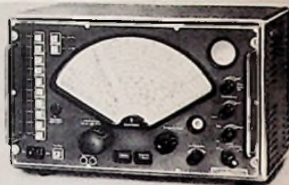
Bild 5. Allwellen-Universalempfänger 745 E 310 mit 11 Bereichen für lückenlosen Empfang zwischen 85 kHz und 30,3 MHz, zuzüglich 14 bis 21 kHz, mit Frequenzlupe und Eichgenerator, für A 1, A 2 und A 3 (Siemens)
