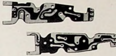
Bild 6. Schaltplatten einer Hörbrille (Siemens)
