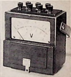
Bild 2. Tragbares Drehspulinstrument mit 1 MΩ/V im Edelholzgehäuse (Siemens & Halske)
