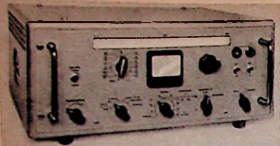
Bild 6. Hf-Analysiergerät Typ Ms 468/1 von Telefunken
